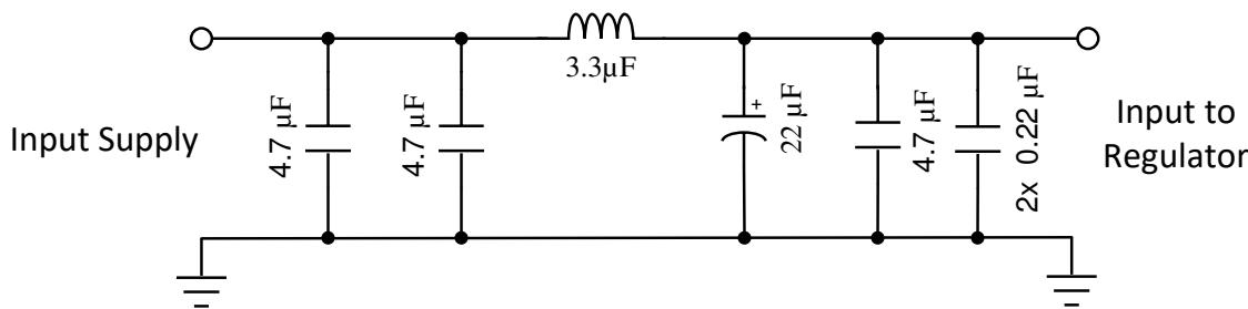
图 20. Typical Input EMI Filter
