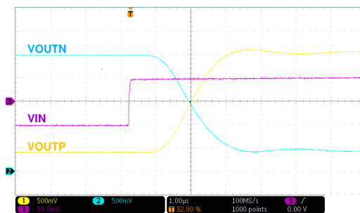
图 8-4. Step Response of the AMC1302-Q1
