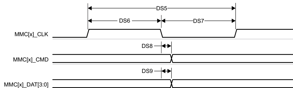
图 7-65. MMC1 - Default Speed - Transmit Mode
