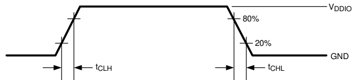
图 6-1. LVC MOS Transition Times
