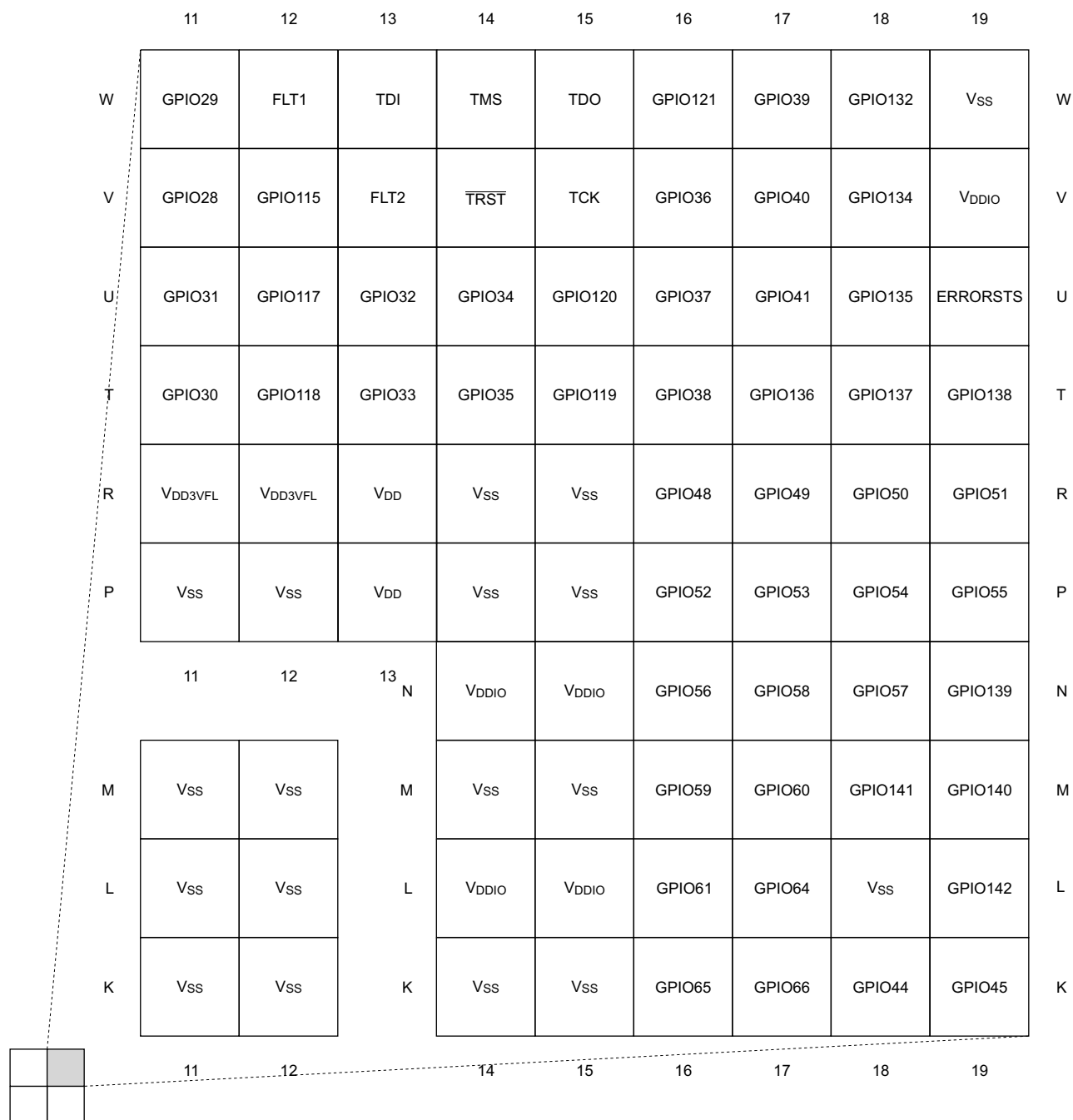
图 6-2. 337 焊球 ZWT 全新细间距球栅阵列 (底视图) - [象限 B]
