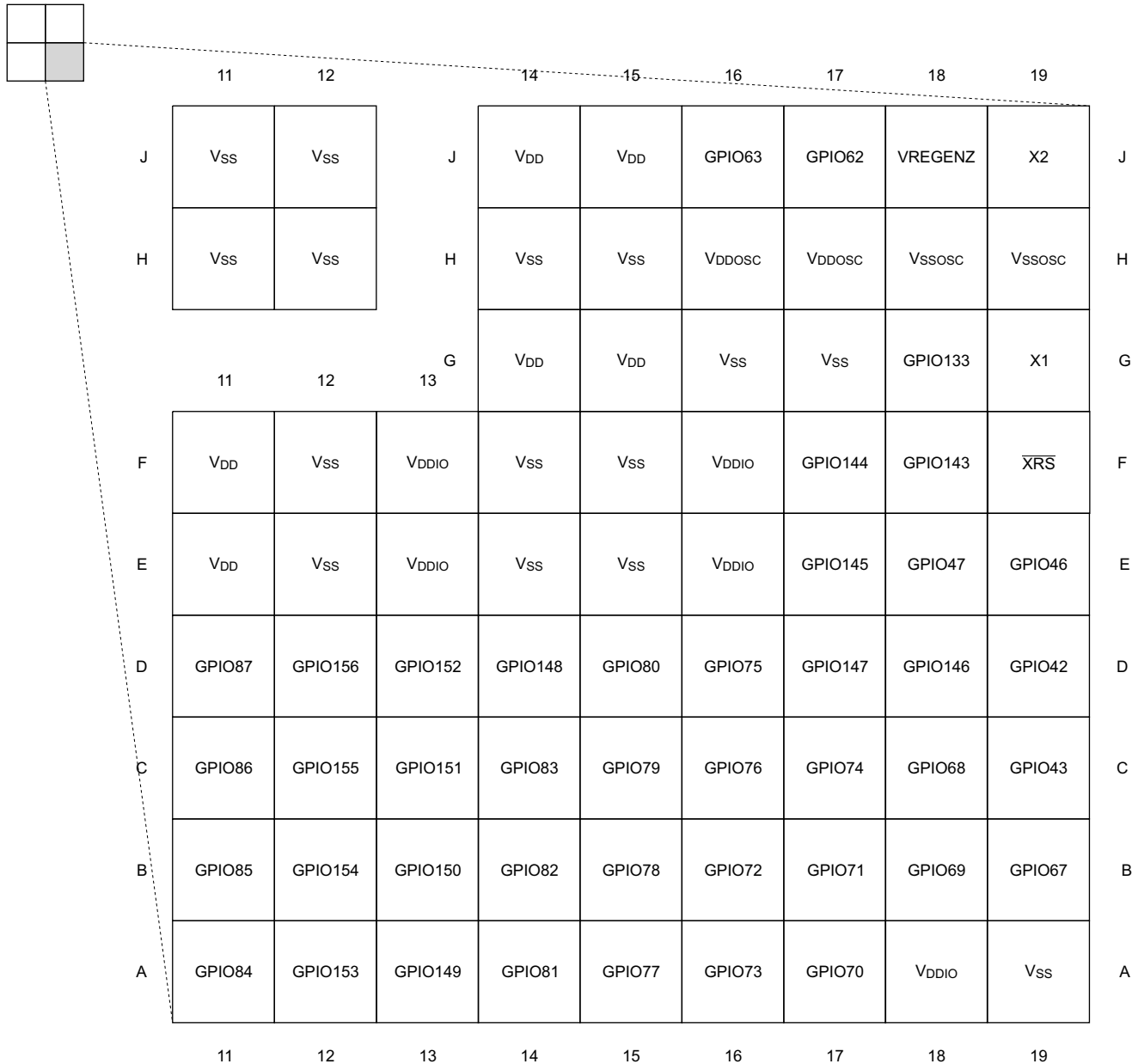
图 6-3. 337 焊球 ZWT 全新细间距球栅阵列 (底视图) - [象限 C]
