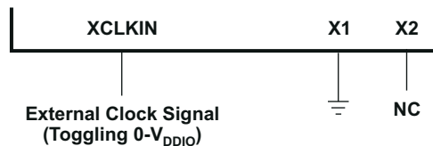
图 8-31. Using a 3.3-V External Oscillator
