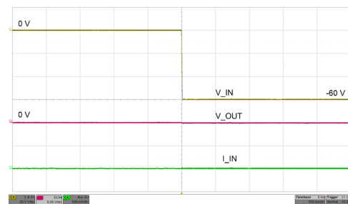
-60V 电源时的反向输入极性保护
